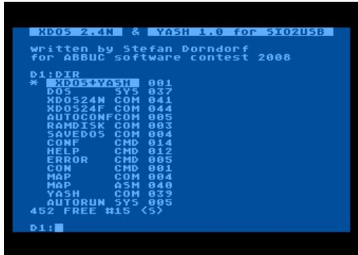
SIO2SD sowie der 1050-Laufwerke mit Speedy-, Happy- und Turbo-Erweiterung. Allerdings ist die Fastversion um 384 Byte länger, d.h. die untere Grenze des freien Speichers liegt höher (\$1F70 statt \$1DF0). Daher kann es Programme geben, die mit der Fastversion nicht funktionieren (viele sind das aber nicht).
